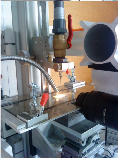
a - En haut à gauche, montage expérimental de réenvol de particules en configuration flux et observation tangentiels. Une fibre optique nous permet d'éclairer les particules.
