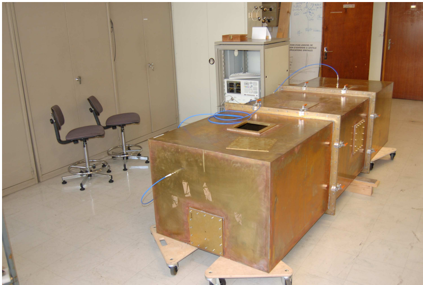
FIGURE 3.1 – Photo du système expérimental générique du DEMR, de trois cavités couplées comprenant des câbles.
