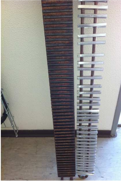
FIGURE 5.1 – a) Photo de l'échangeur utilisé lors des expériences sur prototype (à gauche) et de la plinthe thermique Ecomatic (à droite), b) courbe caractéristique de la plinthe thermique Ecomatic mesurée par l'institut CETIAT ainsi que dans la cellule Passys.
