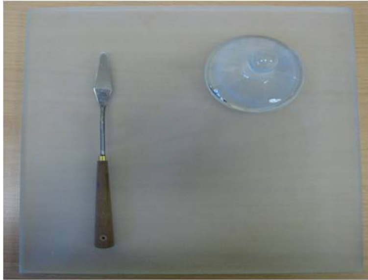
FIGURE 4.1 – Plaque de verre, molette et couteau de peintre utilisés pour la préparation des échantillons-éprouvettes de peinture.
