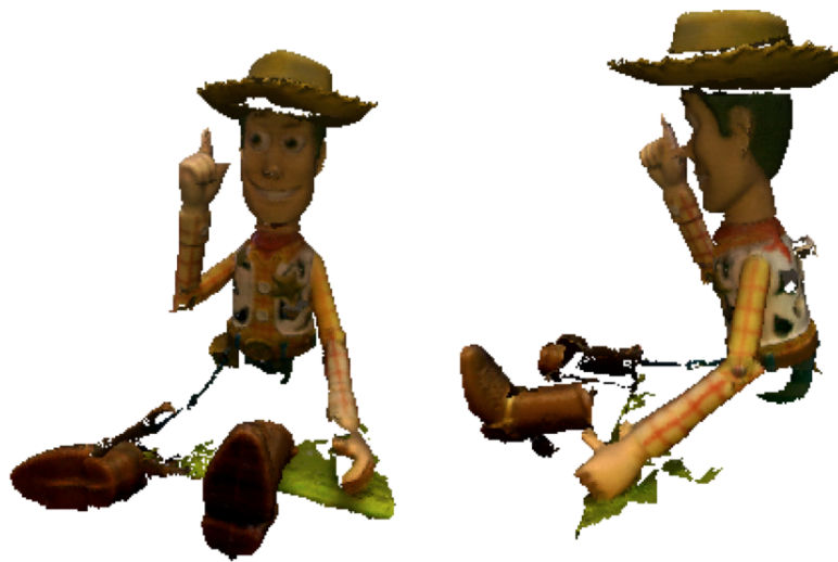
FIGURE 5.6 – Quatorze scans du personnage Woody de la figure précédente assemblés automatiquement grâce au logiciel Konica-Minolta Polygon Editing Tool fourni avec le scanner. Le maillage final a une résolution de 162 196 points et 253 470 faces.
