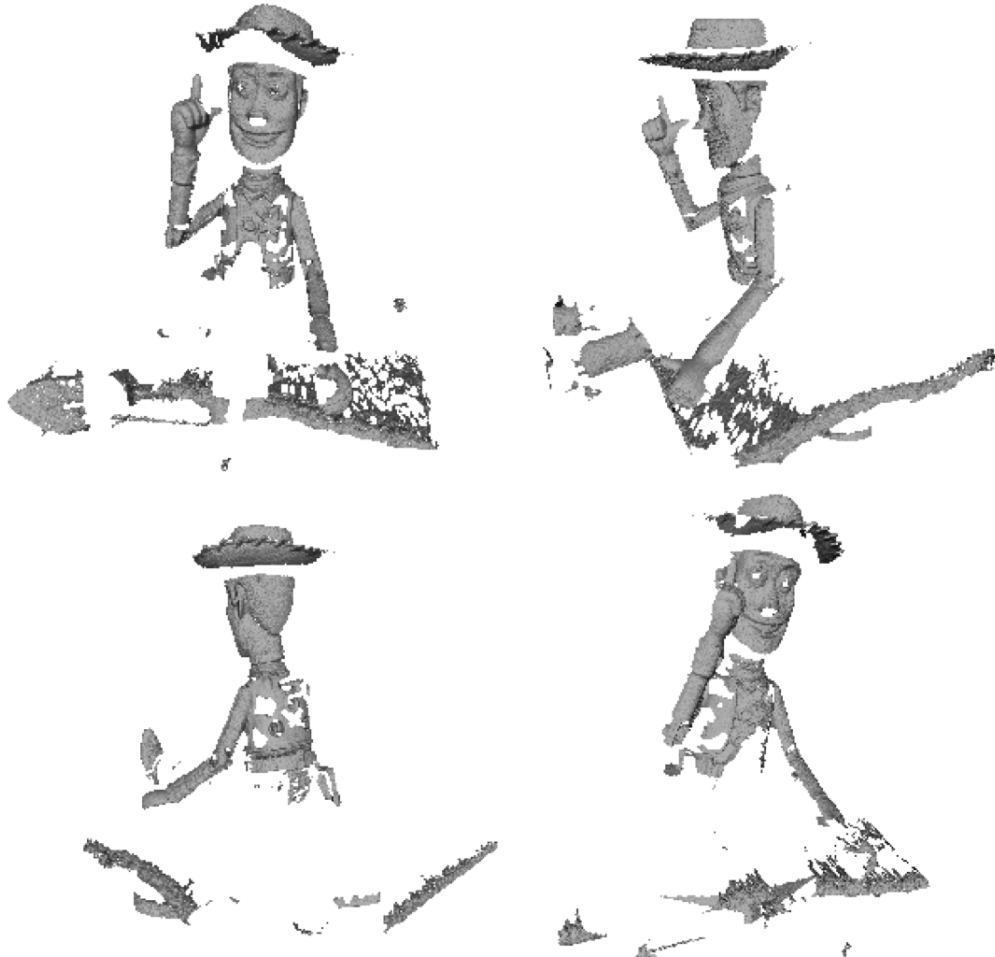
FIGURE 5.5 – Quatre maillages partiels parmi un total de quatorze obtenus par un scanner Konica-Minolta VIVID910 et son plateau tournant, d'un jouet Woody, personnage de Toy Story (®Disney). Chaque maillage a une résolution d'environ 50 000 points et 96 000 faces.
