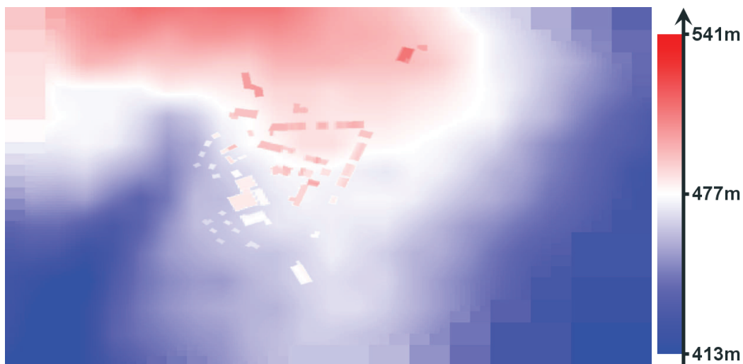
FIGURE 4.8 – Cette figure présente les élévations associées aux cellules de la subdivision présentée à la figure 4.7.
