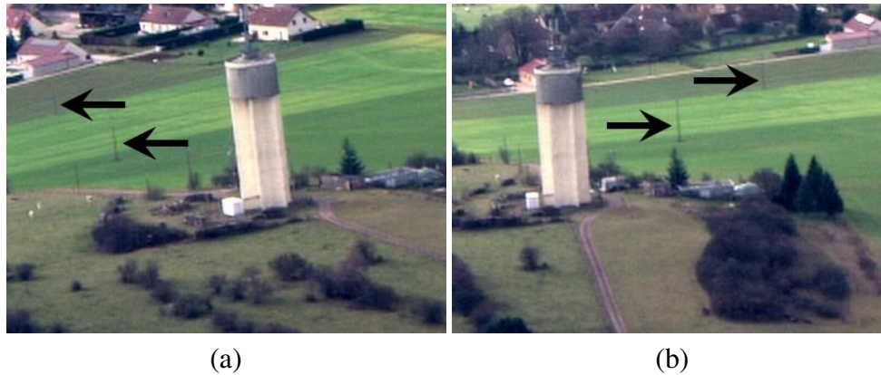
FIGURE 2.3 – Cette figure illustre la manifestation des effets géométriques dans une paire d'images aériennes, acquises sur la même scène selon deux points de vue différents. Par exemple, les objets occultés par le château d'eau dans l'une des deux images ne sont visibles que dans l'autre image. De plus, l'ordre d'apparition de certains objets est modifié, comme c'est le cas pour les poteaux électriques (flèches noires) situés à gauche (a) ou à droite (b) du château d'eau. Copyright © 2010 - 2012 Cassidian - All rights reserved.
