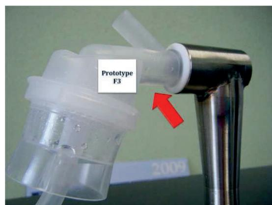
**Figure II.4.** Erreur dans la nébulisation en utilisant le prototype F3 : entrée du liquide dans la partie supérieure du nébuliseur (indiqué par la flèche rouge).
