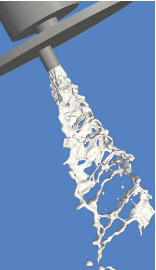
FIGURE 6.26 – Géométrie de l'injecteur à triple disque et nappe liquide simulée sur un maillage de 1,6 milliard de cellules tétraédriques.
