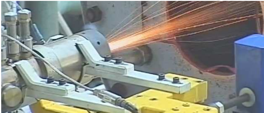
Figure 3.42 : Particules incandescentes éjectées dans le canal de tranquillisation.
