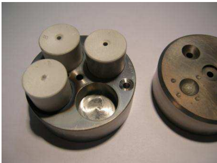
Figure III-13 Creusets utilisés en nitrure de bore- 2 échantillons et la référence en silice pure
