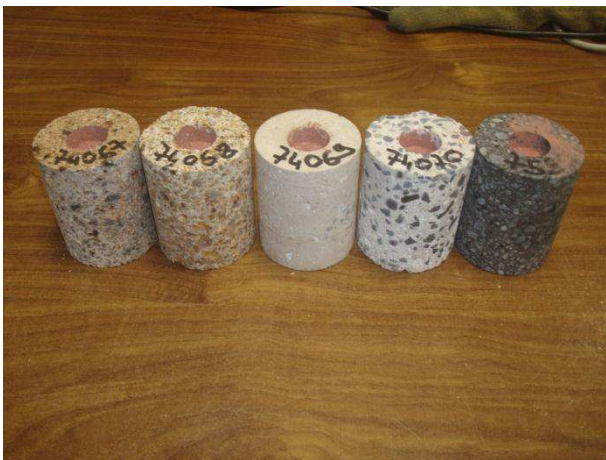
Figure IV-86 Creusets après cuisson et remplissage par le laitier
