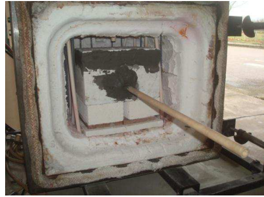
Figure IV-88 Introduction du caisson dans le four d'essai
