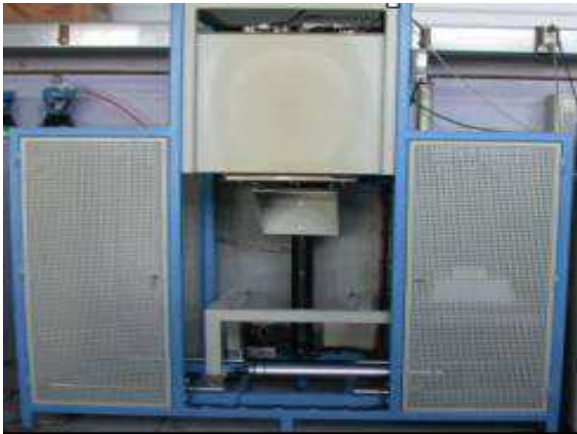
Figure IV-38 four à sole élévatrice utilisé pour les essais
