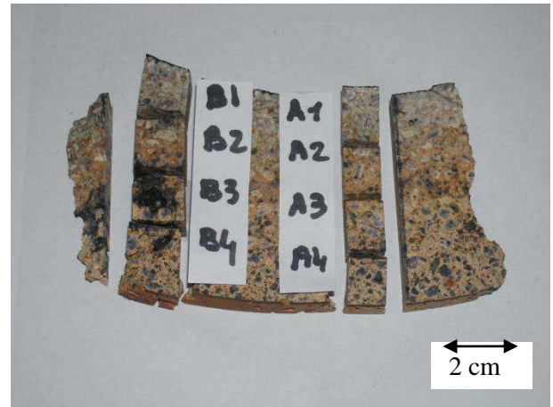
Figure IV-114 Découpe du réfractaire post mortem
