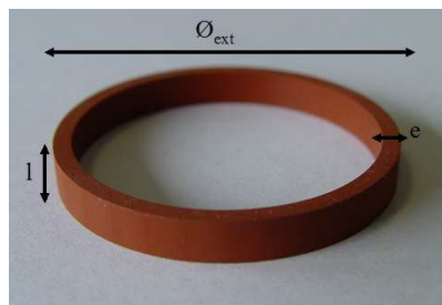
FIG. 1.21 – a) Plot de compression et b) éprouvette de traction de type H2.
