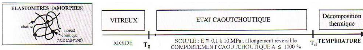
FIG. 1.4 – Etat d'un élastomère en fonction des domaines d'état structural ou de la température [Combette and Ernout, 2005].
