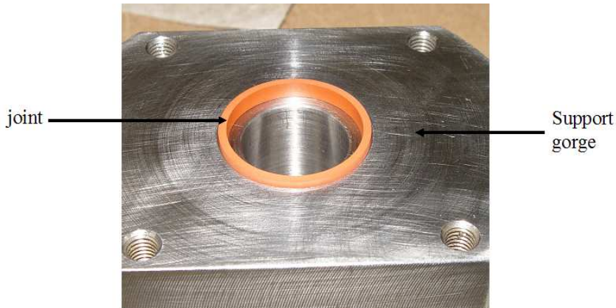
FIG. 3.24 – Dispositif expérimental d'un joint dans une gorge reproduisant un système de filtre à huile.
