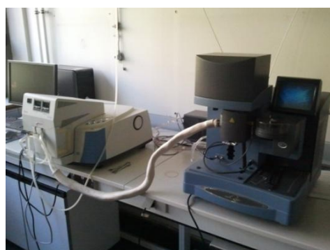
Figure 64. Appareillage TGA 5000 et spectromètre IR NICOLET iS10.
