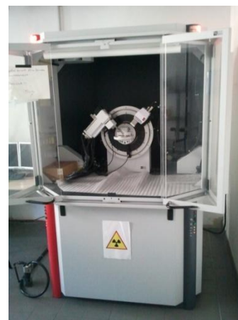
Figure 56. Diffractomètre BRUKER D8 Advance utilisé au LMSPC.
