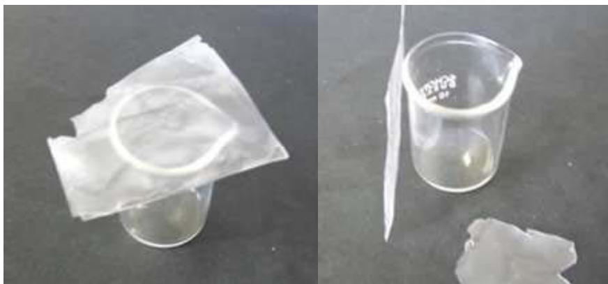
Figure II.3 : Films de cire de paraffine contenant des sensibilisateurs.
