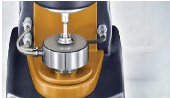
Fig. I. 8. Schéma du rhéomètre avec un module plan-plan
