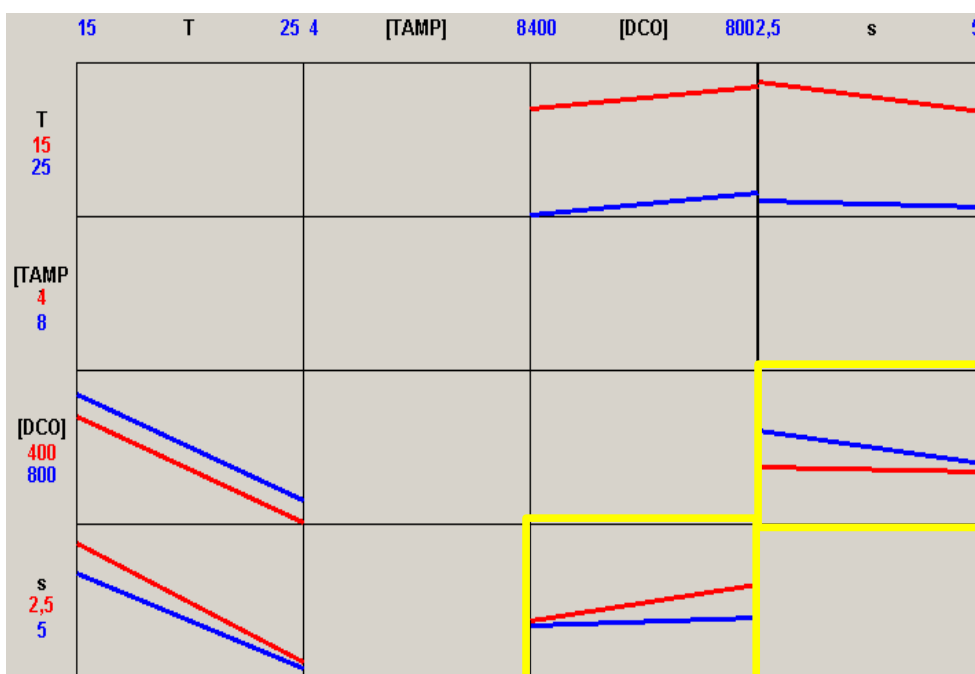
Figure 4.17 : graphique des interactions sur la réponse R_{INT} . Les interactions significatives sont encadrées. Le facteur s correspond à la conductivité \sigma .
