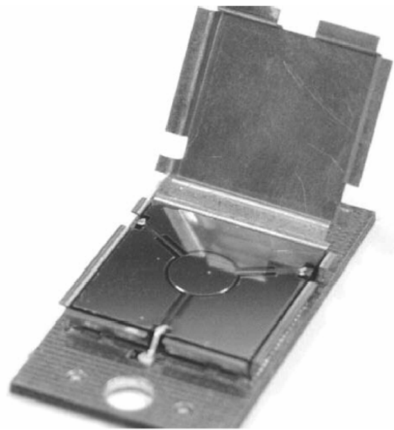
Figure I-15 : Circulateur coplanaire en bande C à base de YIG.
