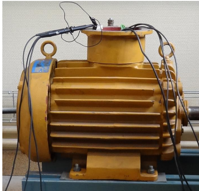
Figure 3.24 Machine asynchrone triphasée à cage d'écureuil de 5,5 kW
