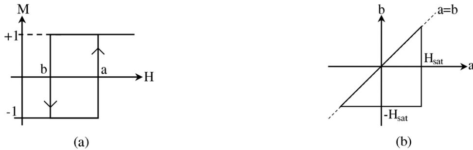
Figure 1.14 a) commutateur magnétique élémentaire, b) plan de Preisach [43]
