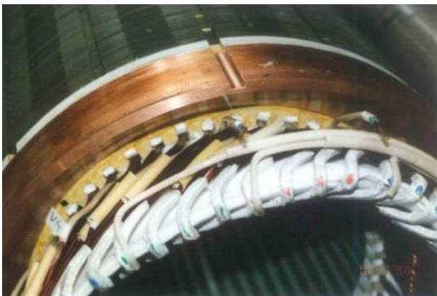
a) Têtes des bobines statoriques
