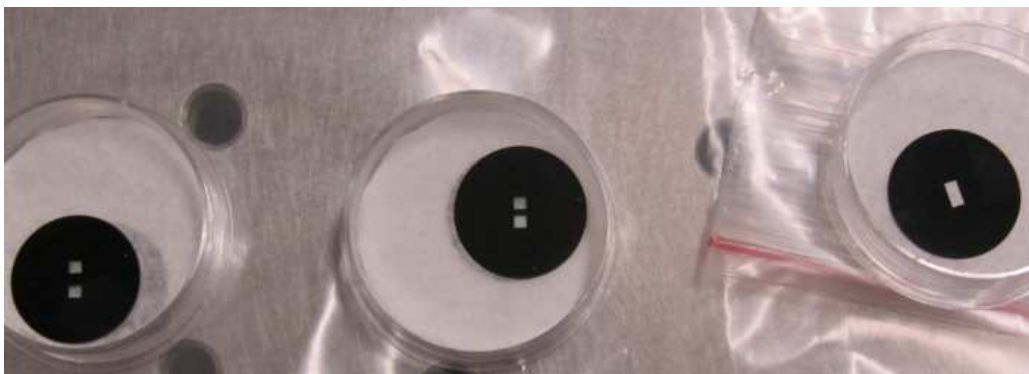
FIGURE 7.31 – Photos des diaphragmes utilisés pour sélectionner les actuateurs : à gauche damiers séparés de 1,2 mm, au milieu damiers séparés de 0,6 \mu m, et à droite damiers jointifs.
