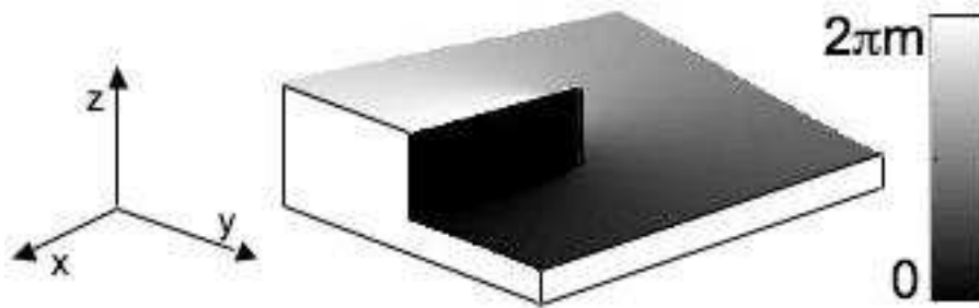
FIGURE 2.33 – Représentation de la topologie du coronographe vortex.
