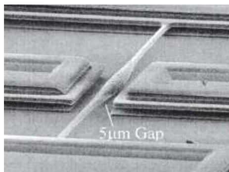
Figure 1.14 Image MEB du dépôt sélectif de polysilicium [50]
