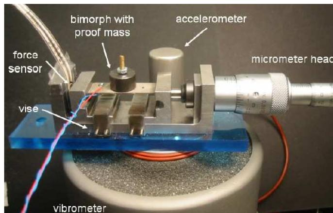
Figure 1.26 Set-up expérimental du système proposé par Leland [61]
