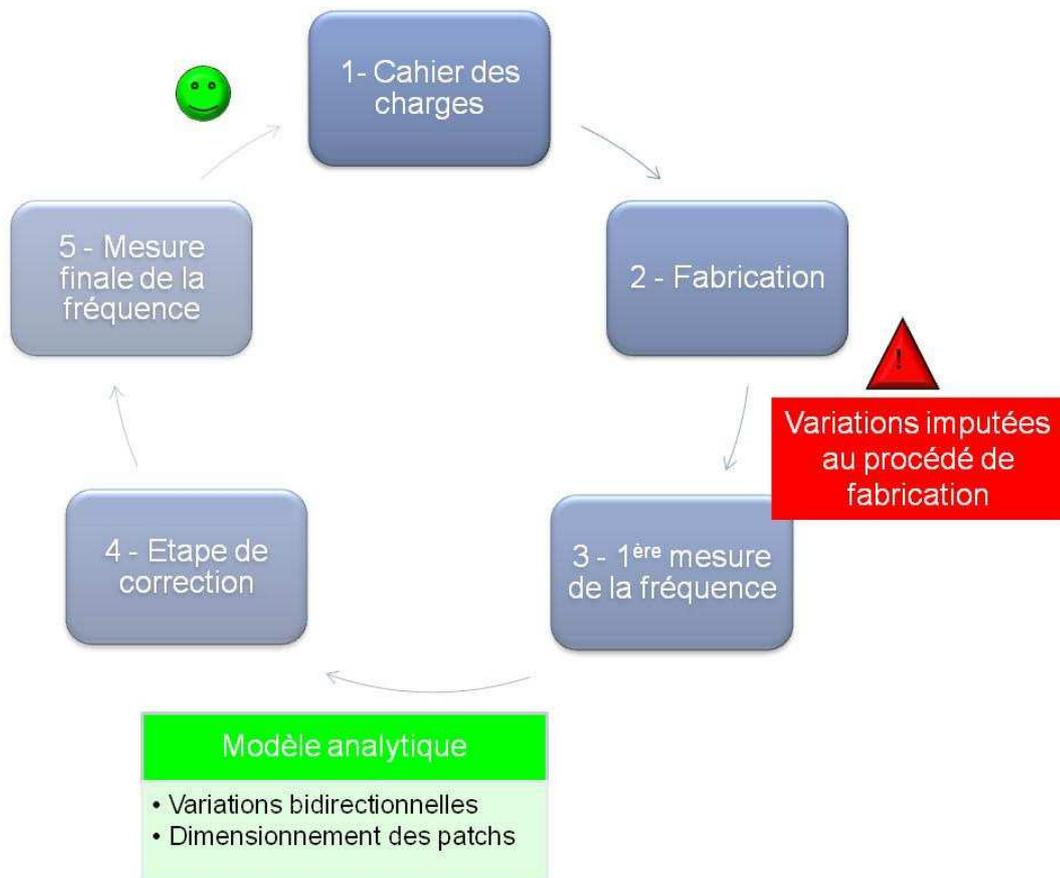
Figure 4 Schéma de principe de la correction "in-line"
