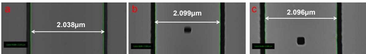
Figure 4.19 Mesure MEB de la largeur des poutres
