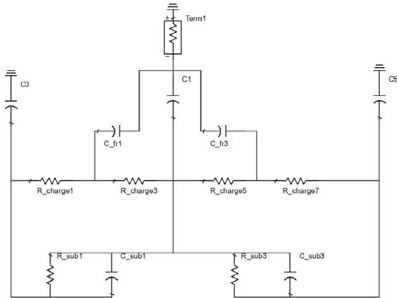
Figure 4.10 Circuit électrique équivalent (plots + substrat +  $C_{fr}$ )
