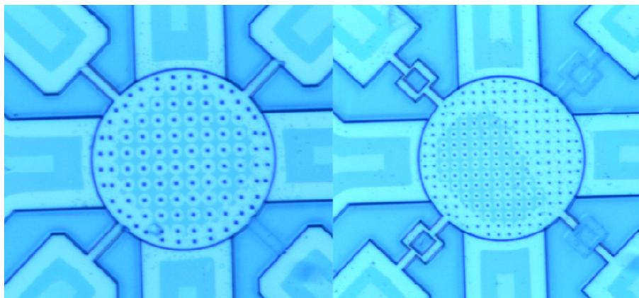
Figure 3.16 Vue de dessus au microscope optique après passage dans le CO<sub>2</sub> supercritique
