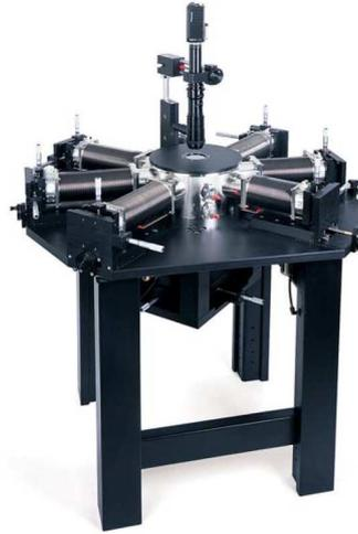
Figure 4.1 Banc cryogénique Lakeshore™
