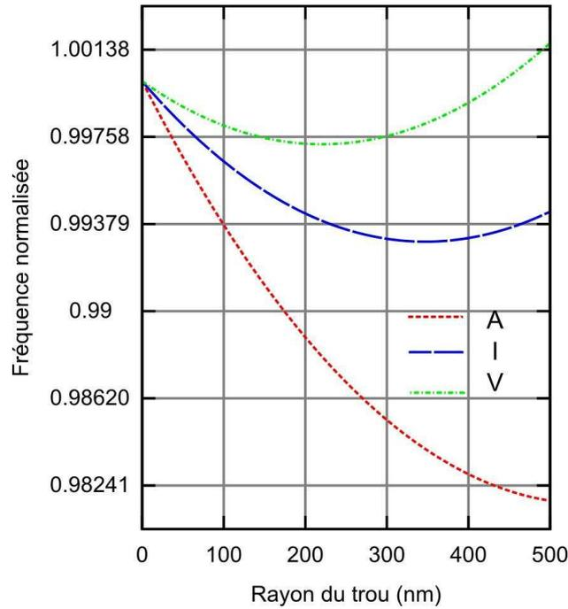
Figure 2.23 Variation de la fréquence fonction de la taille d'un trou pour les 3 zones (« V » =  $25\mu\text{m}$ , « I » =  $10\mu\text{m}$ , « A » =  $5\mu\text{m}$ )
