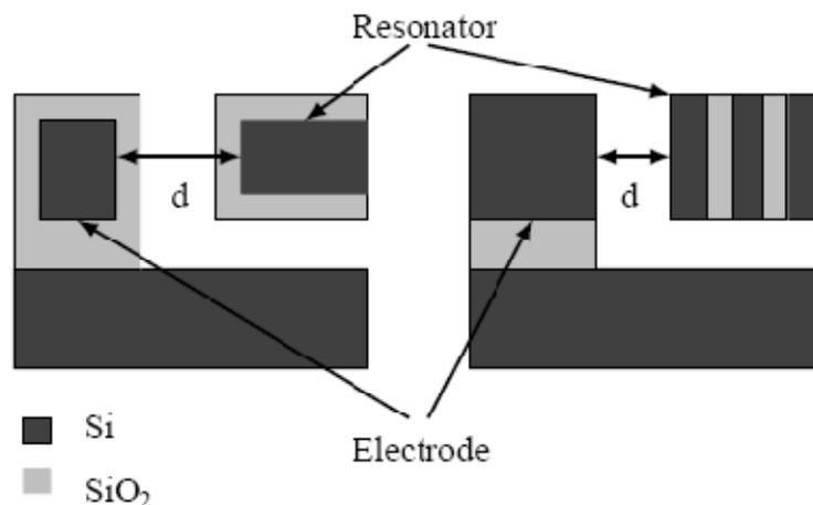
Figure 1.20 Compensation en température par un matériau composite Si/SiO<sub>2</sub> [42]
