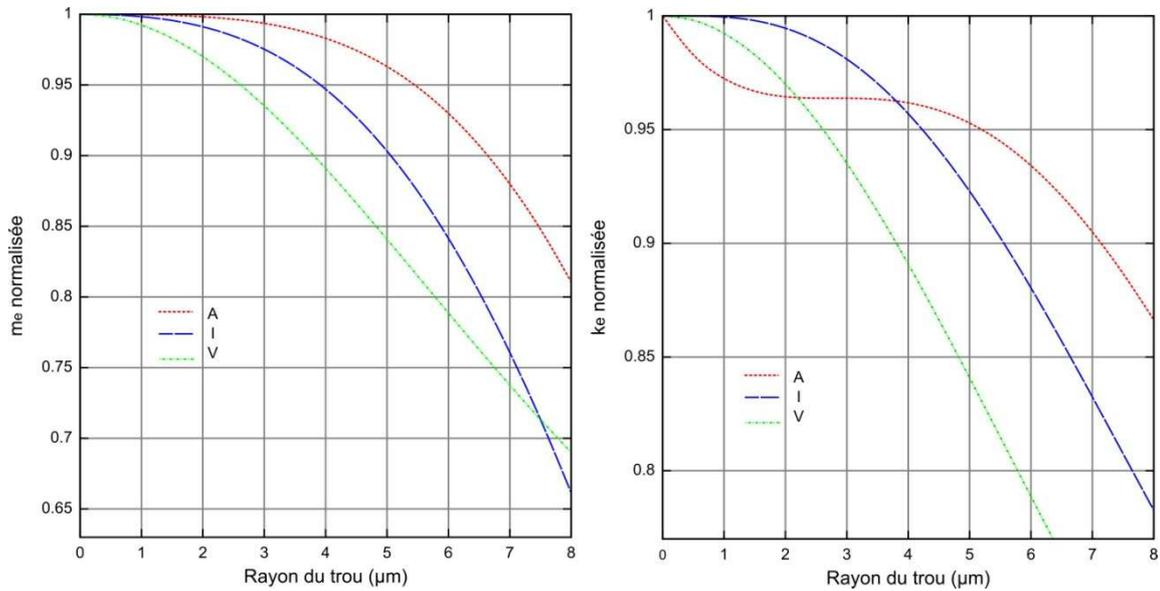
Figure 2.9 Variation de la masse et de la raideur effective en fonction de la taille d'un trou pour les 3 zones (« V » =  $25\mu\text{m}$ , « I » =  $10\mu\text{m}$ , « A » =  $5\mu\text{m}$ ,  $f_i = 4.9192\text{MHz}$ )
