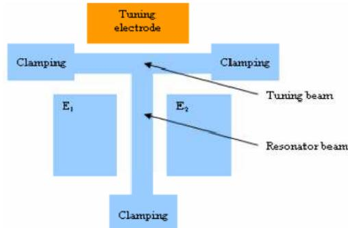
Figure 1.27 « Design du tuning beam » [30]
