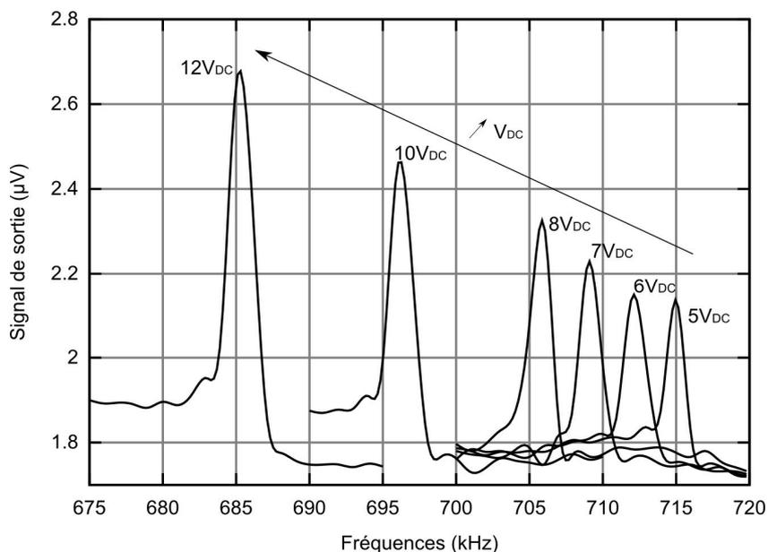
Figure 4.17 Variation de la fréquence de résonance pour différentes tensions  $V_{DC}$ ,  $V_{AC} = 0.2V$ ,  $P = 10^{-3}mBar$
