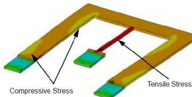
Figure 1.22 Simulation (FEM) de la contrainte dans une poutre compensée en température [57]
