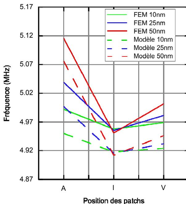
Figure 2.40 Comparaison des simulations et du modèle dans le cadre de la correction localisée ( $A, I, V$  :  $patches\ 2 \times 9 \times 20\mu m^2$ ) pour plusieurs épaisseurs
