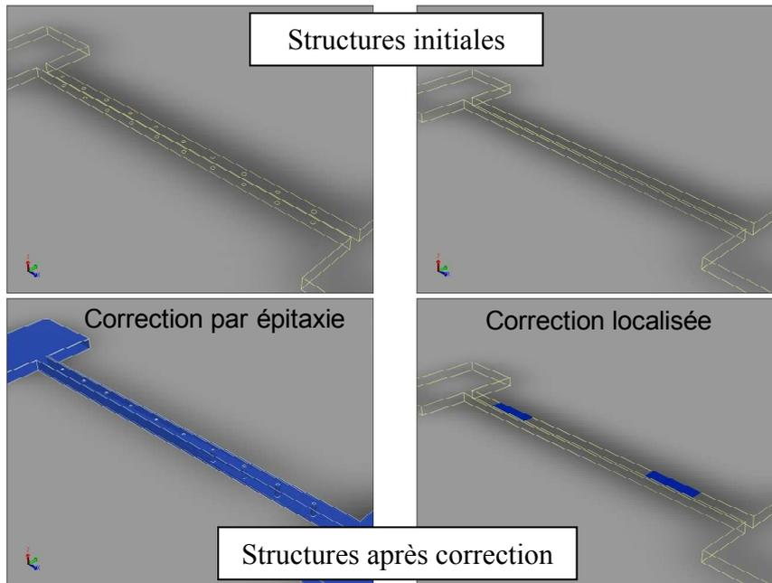
Figure 1.38 Schéma de principe de la correction par épitaxie ou localisée
