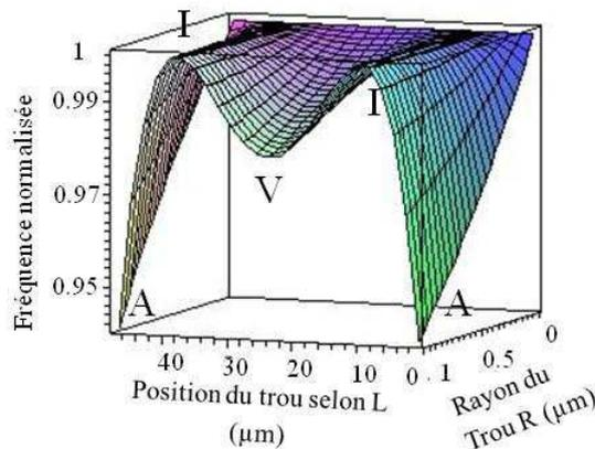
Figure 2.3 Variation de la fréquence de résonance en fonction du rayon d'un trou et de la position de ce dernier ( $L = 50 \mu\text{m}$ ,  $W = 20 \mu\text{m}$ ,  $h = 1.4 \mu\text{m}$ ,  $f_i = 4.9192 \text{ MHz}$ )
