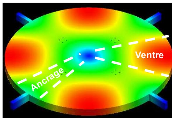
Figure 2.27 Définition des zones "Ventres" et "Ancrages" sur une simulation modale
