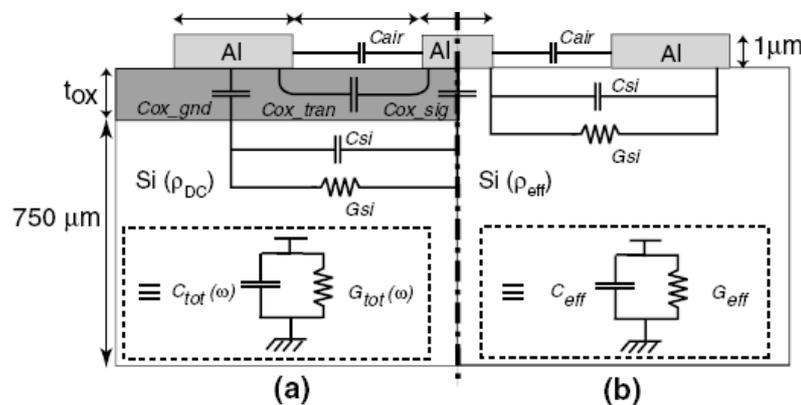
Figure 4.5 Modélisation électrique de l'effet substrat SOI pour des structures coplanaires [97]
