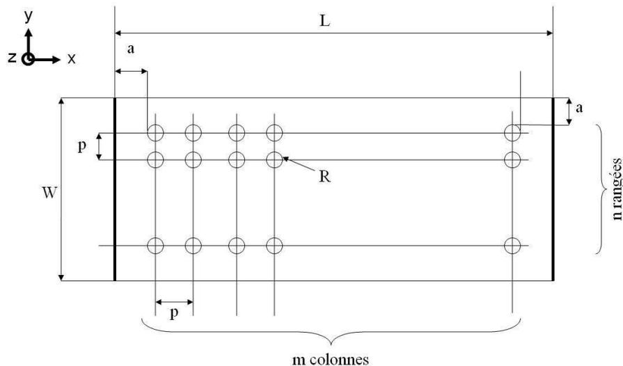
Figure 2.10 Schéma d'une poutre présentant un réseau de trous
