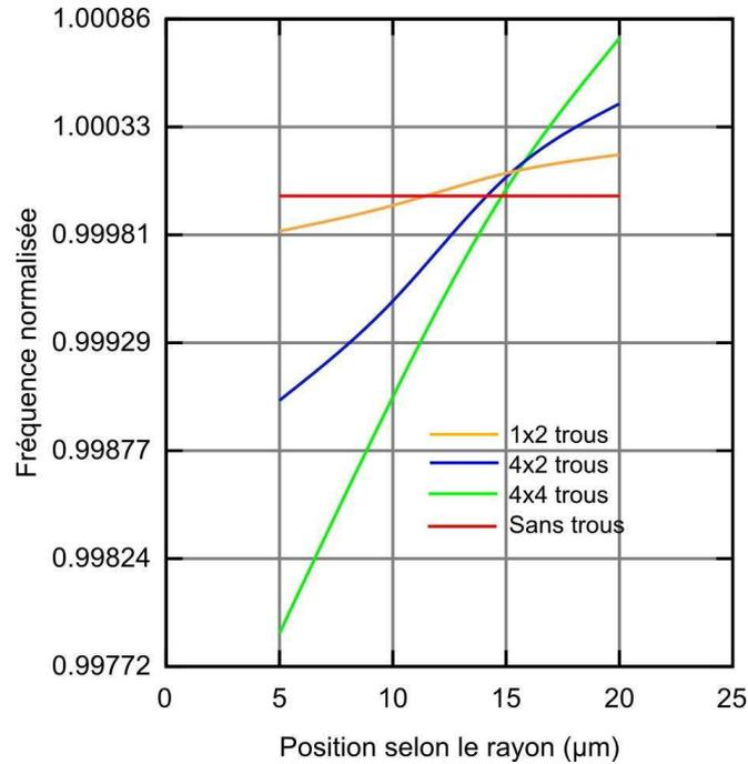
Figure 2.30 Variation de la fréquence en fonction de la position suivant le rayon en position "Ventre" ( $f_i=95.71\text{MHz}$ ,  $R=19,88\mu\text{m}$ )
