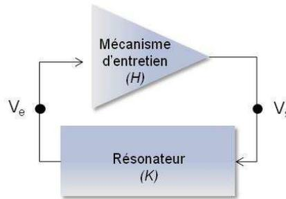
Figure 1.1 Schéma d'un système contre-réactionné à deux ports
