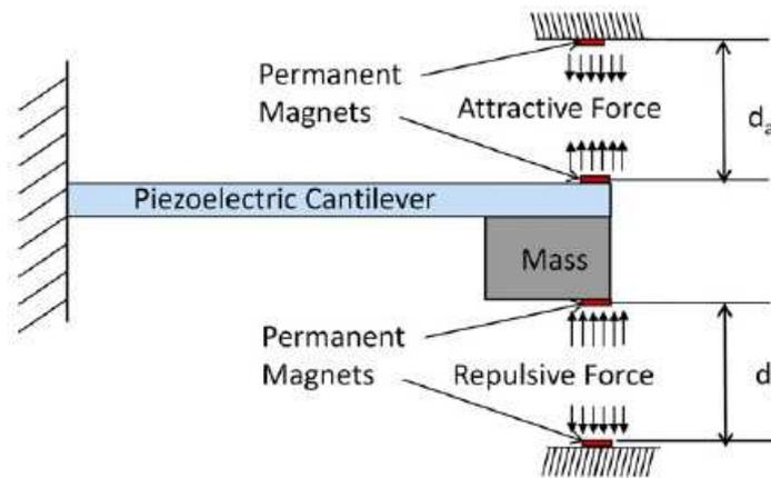
Figure 1.35 Schéma d'un système de récupération d'énergie adaptable en fréquence [68]
