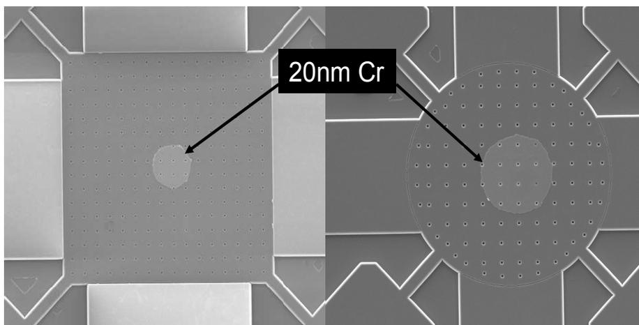
Figure 3.15 Vue au MEB du dépôt localisé de chrome sur les structures à ondes de volume
