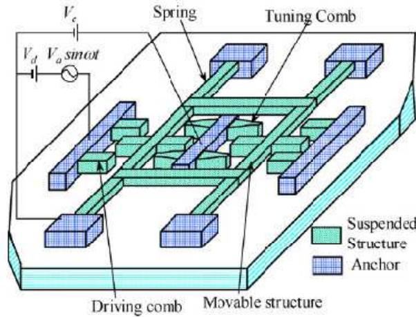
Figure 1.30 Résonateur ajustable grâce à la tension  $V_c$  [63]
