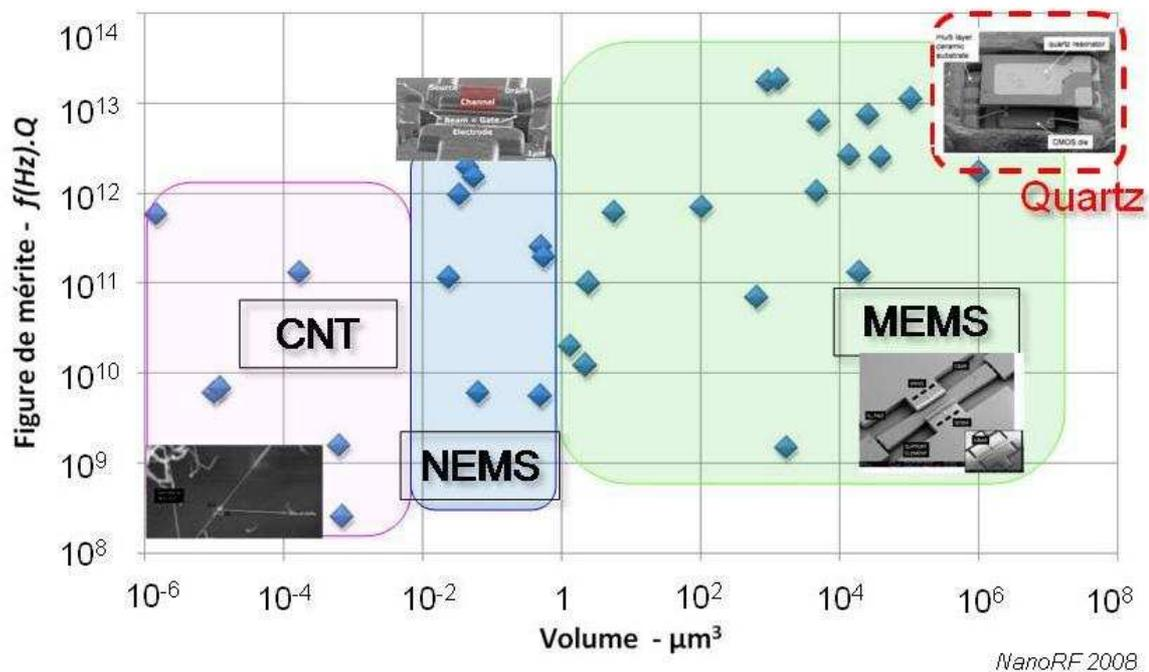
Figure 3 Etat de l'art des performances des MEMS ( $f \cdot Q$ ) par rapport au Quartz<sup>2</sup>
