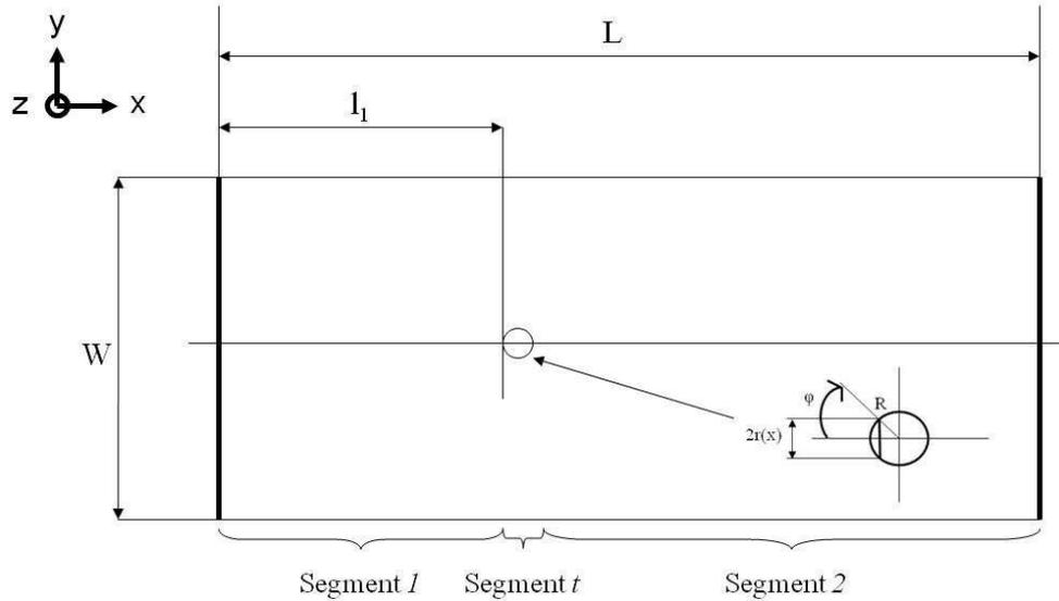
Figure 2.2 Schéma d'une poutre comportant un seul trou
