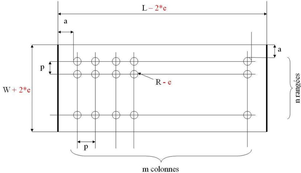
Figure 2.35 Schéma d'une poutre pour correction par épitaxie
