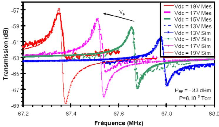
Figure 1.36 Réponse fréquentielle d'une poutre bi-encastree pour différentes tensions de polarisation (expérimentales et simulations) [69]
