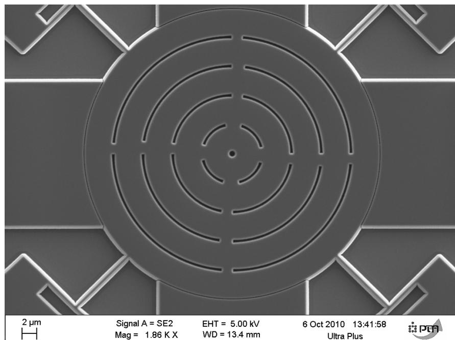
Figure 3.5 Vue de dessus d'un disque après gravure du SiO<sub>2</sub> et du Silicium
