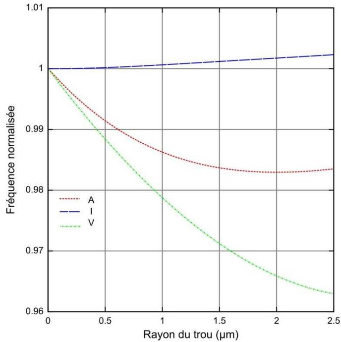
Figure 2.6 Variation de la fréquence fonction de la taille d'un trou pour les 3 zones (« V » = 25µm, « I » = 10µm, « A » = 5µm,  $f_i = 4.9192\text{MHz}$ )
