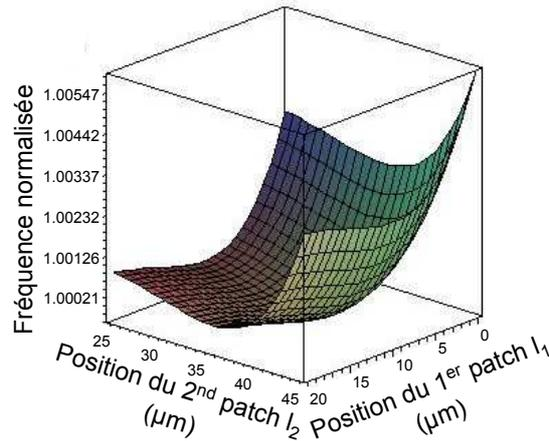
Figure 2.38 Variation de la fréquence d'une poutre pourvue de deux patches (Silicium :  $5 \times 20 \mu\text{m}^2$ ) en position "I" en fonction de la position de ces derniers ( $f_i = 4.9192\text{MHz}$ )
