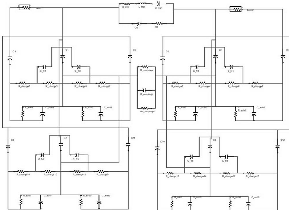
Figure 4.27 Modèle électrique complet du résonateur disque
