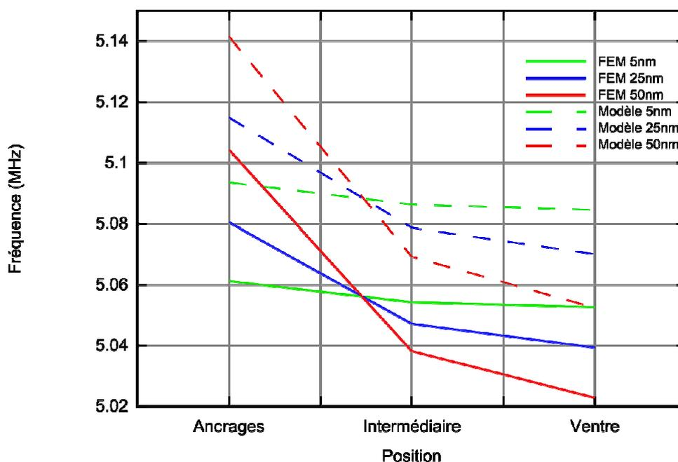
Figure 2.41 Comparaison du modèle et des simulations pour une correction localisée en différents lieux pour plusieurs épaisseurs de matériau ajouté ( $L=20\mu\text{m}$ ,  $W=1.5\mu\text{m}$ ,  $\text{Longueur patch} = 2x9\mu\text{m}$ )
