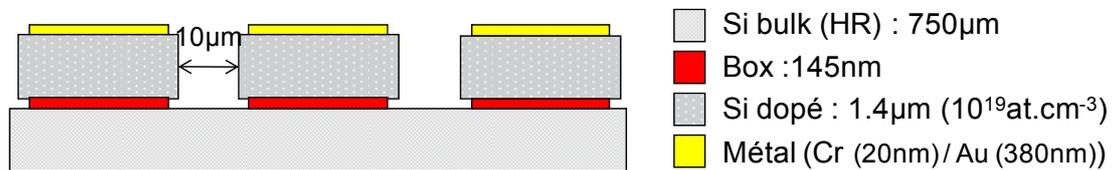
Figure 4.4 Schéma en coupe du pad utilisé pour la modélisation du substrat
