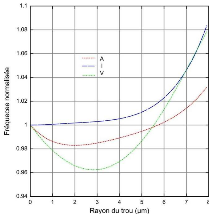
Figure 2.8 Variation de la fréquence en fonction de la taille d'un trou pour les 3 zones (« V » =  $25\mu\text{m}$ , « I » =  $10\mu\text{m}$ , « A » =  $5\mu\text{m}$ ,  $f_i = 4.9192\text{MHz}$ )
