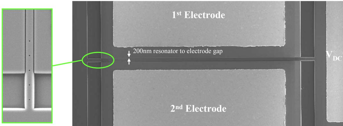
Figure 4.16 Vue MEB d'une poutre caractérisée en 2 ports
