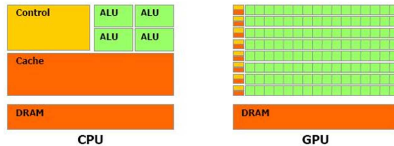
Figure 2-9 : Stratégie des architectures CPU et GPU.
