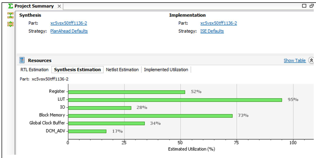
Figure 5-17 : Rapport de synthèse pour FPGA xc5vsx50t
