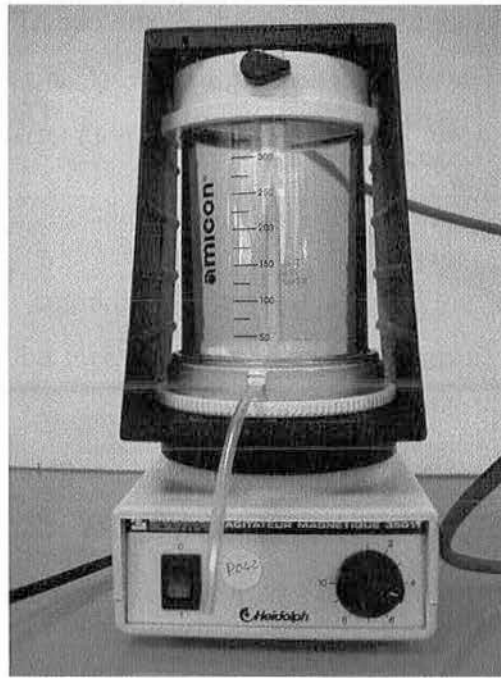
Figure II.1 Montage du système d'ultrafiltration
