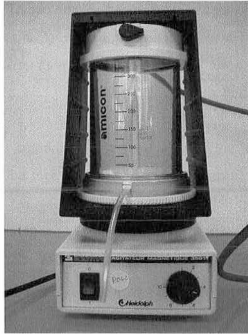
Figure II.1 Montage du système d'ultrafiltration
