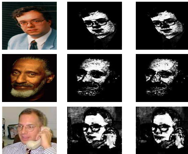
FIGURE 3.4 – Quelques entrées et sorties de deux détecteurs de peau. Les images de la deuxième et troisième colonne correspondent respectivement à celles obtenues par le détecteur fondé sur l'arbre de Chow Liu et celui à base de l'arbre de dépendances à bi-probabilité peau et non peau Simple.
