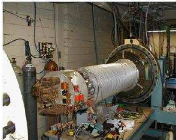
(b) Accélérateur Van de Graaff de 2 MeV datant des années 1960 ouvert pour maintenance.
