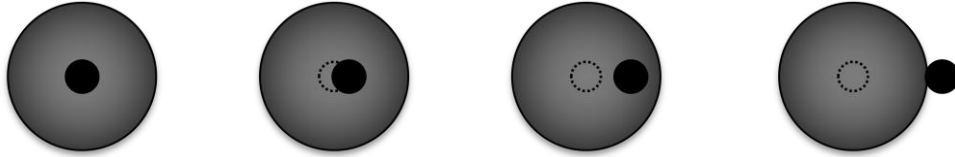
Figure 106: déplacement de la nanoparticule d'Or dans la matrice d'oxyde mixte SiO_2-TiO_2 avec l'augmentation de la quantité de TiO_2 .
