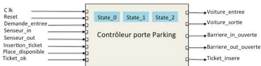
Figure III.16 : États internes du circuit contrôleur de parking
