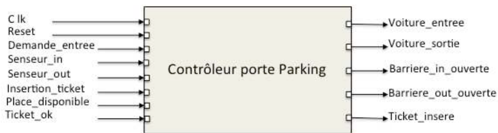
Figure II.12 : Interface du contrôleur de barrière de stationnement
