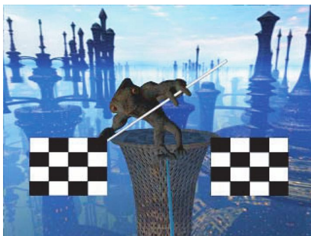
Fig. I.18 – Exemple de BCI utilisant le SSVEP [Lalor et al., 2005]. Le personnage avance sur la corde et l'utilisateur doit l'aider à se stabiliser en portant son attention sur le damier clignotant situé du bon côté (dans le cas présent, celui de droite). Les deux damiers clignotent à des fréquences différentes. Quand l'utilisateur porte son attention sur l'un des damiers, la puissance à cette fréquence de stimulation augmente dans le cortex visuel, ce qui permet de déterminer quelle cible il veut sélectionner.
