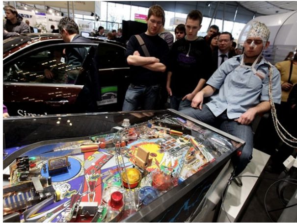
Fig. I.23 – Flipper commandé par une ICM. Démonstration du Berlin brain-computer interface group au CeBit exhibit à Hannover (Allemagne) [Tangemann et al., 2009]. Pour actionner la commande de droite il suffit au joueur d’imaginer un mouvement de la main droite et pour actionner celle de gauche il doit penser à bouger sa main gauche. Le simple fait que le sujet imagine un mouvement de ses mains fait varier la puissance dans les bandes de fréquences \mu et \beta ce qui est traduit en commandes par l’ICM.
