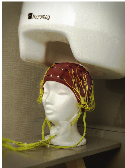
Figure 1.16 – Un système MEG couplé à un EEG moderne.
