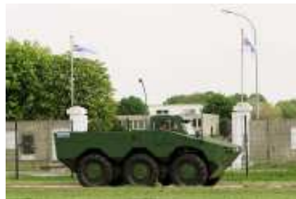
Figure 1.24 Véhicule hybride série DPE 6x6 de Nexter systems - DGA [Boulon09]
