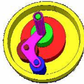
Figure 1.53 Profil du train ravigneaux (planétaire double étage) de Nexter Systems
