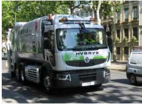
Figure 1.20 Camion de ramassage d'ordures ménagères hybride parallèle de Renault Trucks en France [Renault]
