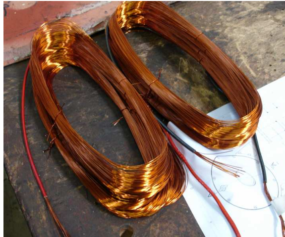
Figure 4.16 Cuivres pour les bobinages de la machine prototype
