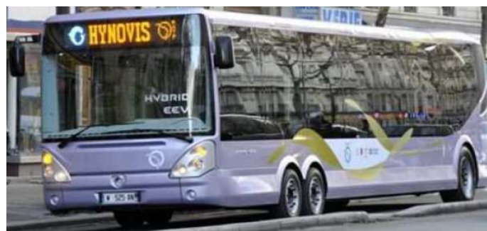
Figure 1.18 Modèle Hynovis de bus hybride hydraulique d'Irisbus Iveco en France [Irisbus10]
