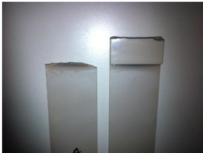
Figure IV. 17. Rupture d'éprouvette PEEK90G dans le substrat.
