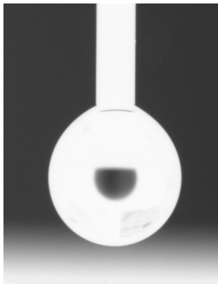
Figure III. 10. Goutte d'eau pendue à l'aiguille de la seringue juste avant le dépôt sur la surface à caractériser.
