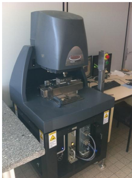
Figure II. 16. Topomètre 3D (Interféromètre optique).
