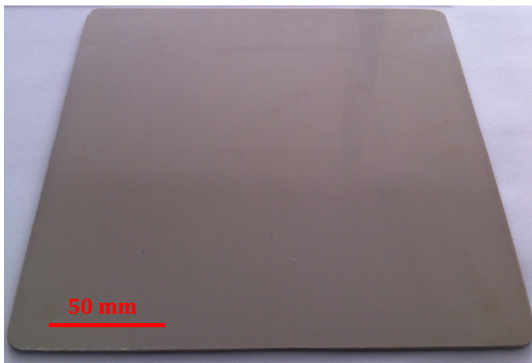
Figure I. 16. Plaque injectée du PEEK 90G.
