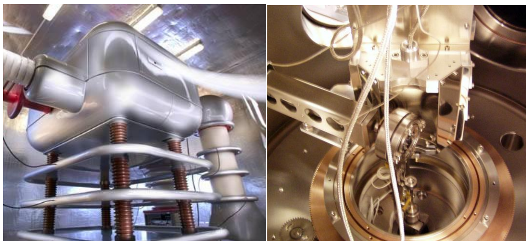
Figure IV.1 : MEIS à Grenoble MINATEC: (à gauche) étage de haute-tension comprenant la source ionique et (à droite) goniomètre et TEA.
