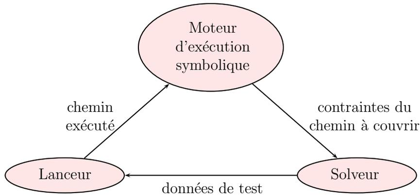
FIGURE 3.10 – Phase de génération de tests dans PATHCRAWLER
