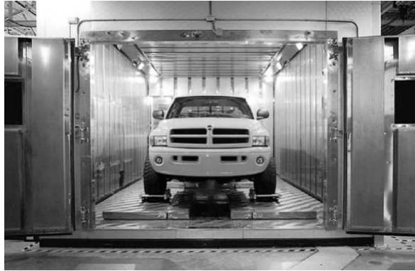
FIGURE 1.2 – Banc à rouleaux (Cerrato-Jay [15])
