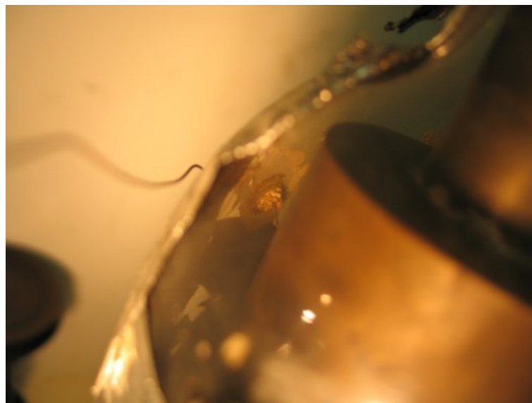
FIGURE 4.5 – Traversée au niveau du dispositif de déviation électrique - Vue intérieure.
