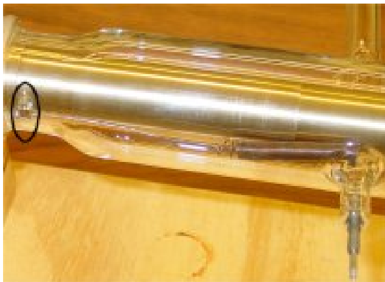
FIGURE 4.15 – La connexion électrique entre l'électrode positive et l'extérieur est assurée par un ressort soudé à une extrémité (à droite) à la traversée verre/métal, et pouvant être attaché à l'autre extrémité à une pièce de laiton spécialement conçue à cet effet.
