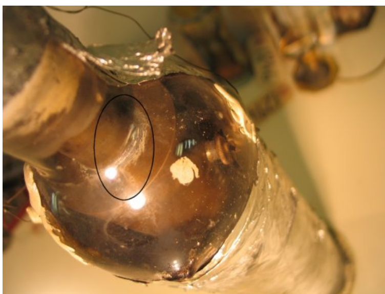
FIGURE 4.9 – Soudure entre l'anode et le cylindre D support du dispositif de déviation électrique.
