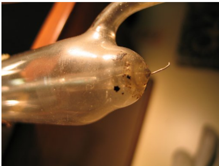
FIGURE 4.6 – Traversée verre-métal au niveau de la cathode.
