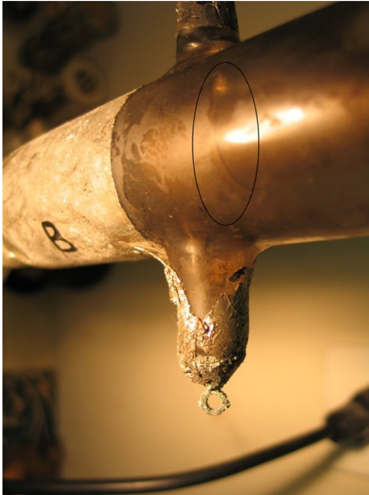
FIGURE 4.11 – L'anode est constituée de deux cylindres coulissant l'un dans l'autre.
