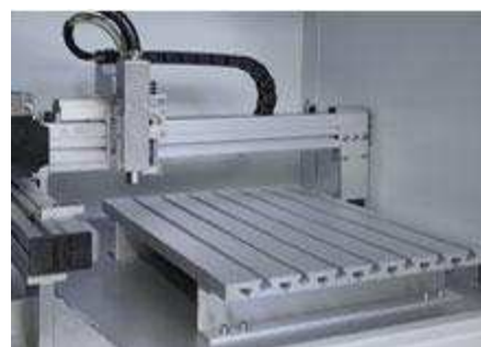
Figure 2.12 La torche plasma se déplace à l'aide d'un robot 2 axes. Le déplacement de la torche permet de contrôler le temps de traitement du substrat [5].
