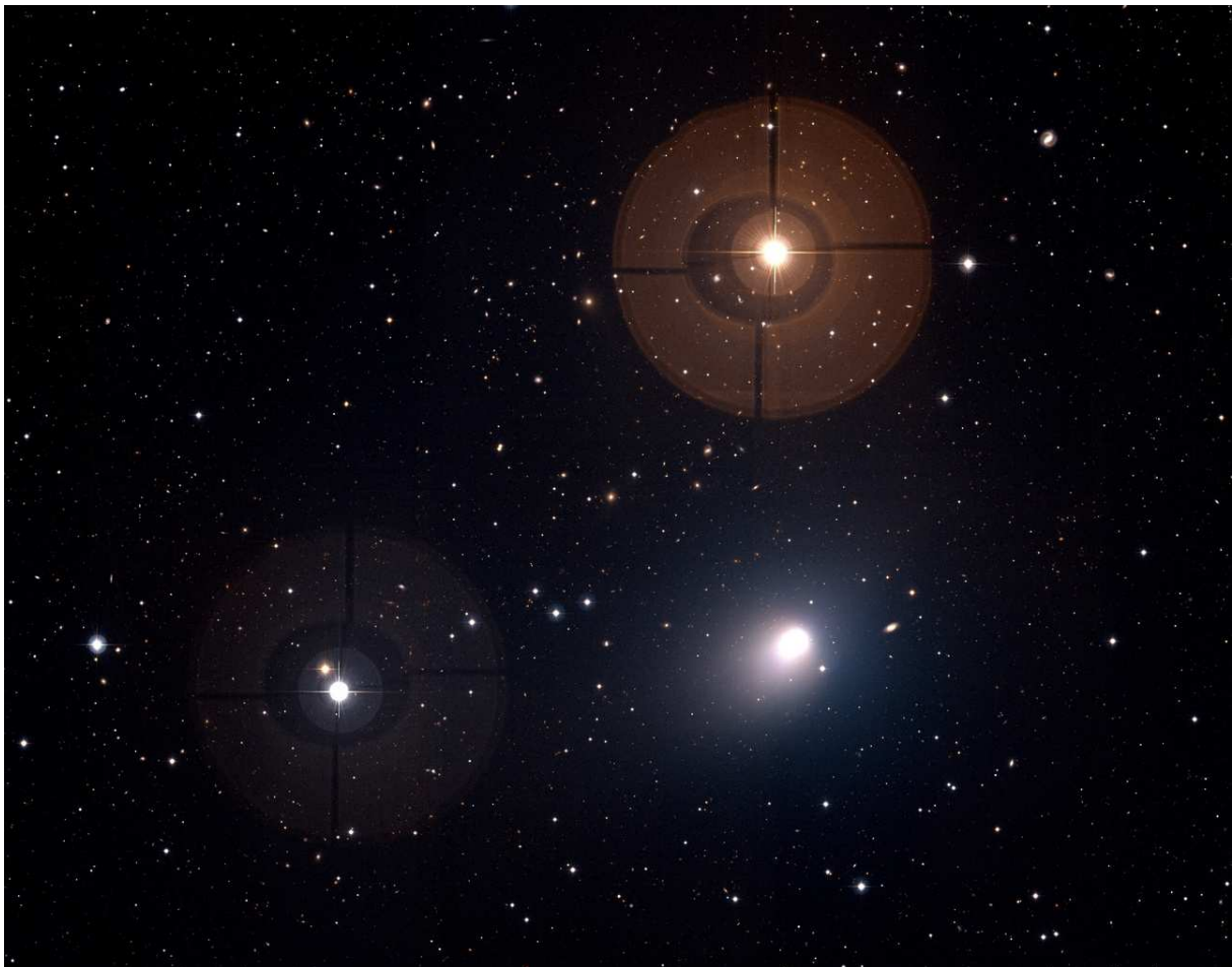
Fig. 5.3.: Exemple d'image, enregistrée par MegaCam. En regardant les taches produites par les l'étoiles, il est possible de distinguer la couronne circulaire, qui reproduit la forme du miroir primaire et de l'araignée de soutien. Le halo est causé par la fraction de lumière provenant de l'étoile réfléchi par l'optique de l'imageur.
