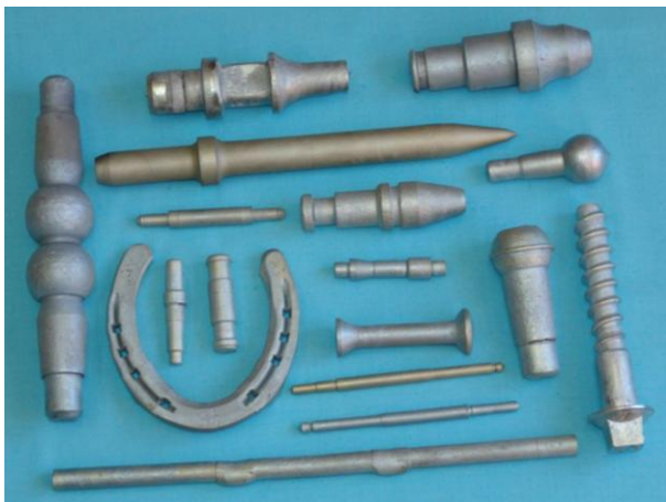
Figure 11 - Exemples de pièces obtenues par laminage transversal et éventuellement d'autres opérations ultérieures [PTI Minsk]
