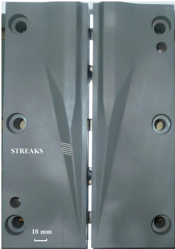
Figure 138 - Vue de dessus des demi-matrices en fin de fabrication
