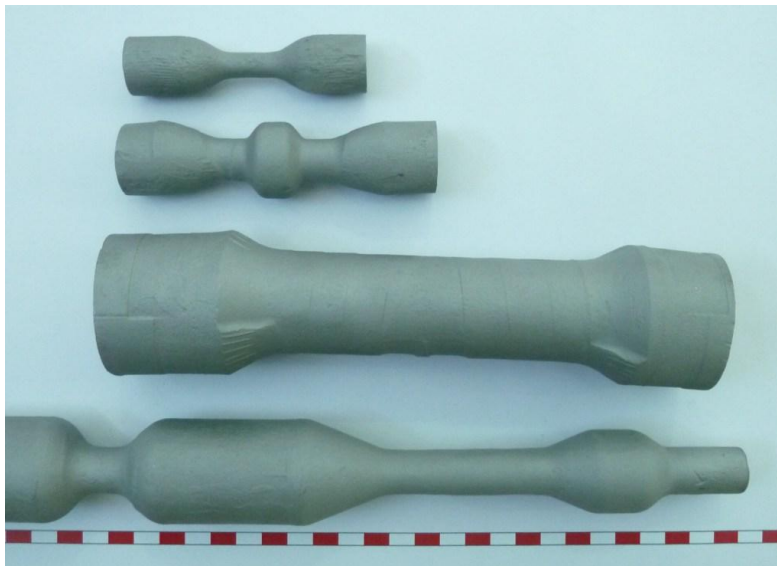
Figure 18 - Aperçu des préformes étudiées dans le cadre de cette thèse
