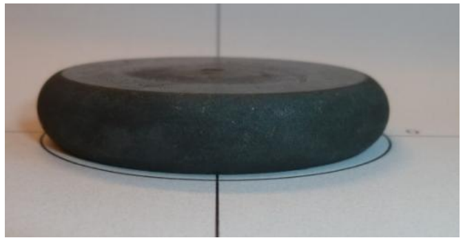
Figure 154 - Vue du lopin après refoulement
