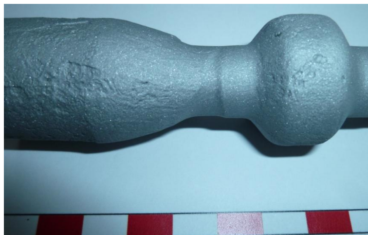
Figure 94 - Cratères résiduels visibles sur la peau de préformes 9026 à l'issue du laminage [ENSAM/THESE]
