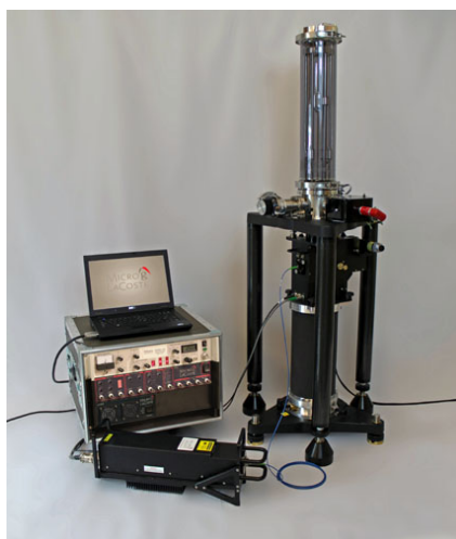
(a) Photographie de FG5 (image Scintrex Ltd)
