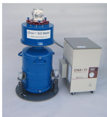
(a) Photographie du gravimètre iGrav de GWR.
