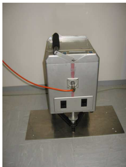
FIGURE 4.16: Gravimètre sur sol mou, stabilisé à l'aide d'une plaque en métal. Image Sophie Dorizon [Dorizon, 2010].
