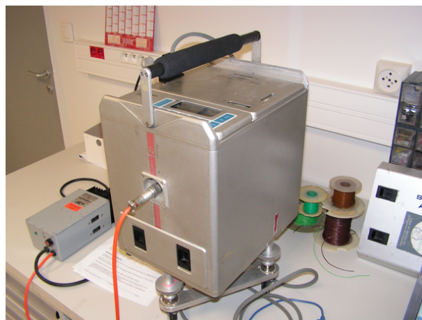
FIGURE 4.10: Gravimètre Scintrex CG3 utilisé dans le cadre des mesures à Palaiseau en 2009 et 2010.
