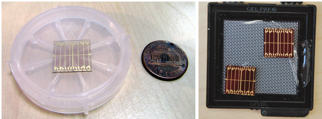
(a) Puce en carbure de silicium utilisée lors de la première étape de la démarche expérimentale. La pièce de monnaie donne l'échelle. (b) Pucés en silicium similaires à celle montée sur la deuxième cellule.
