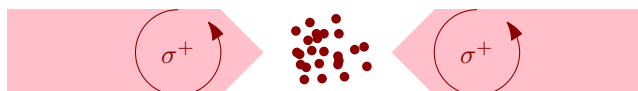
FIGURE 9.2: Configuration de polarisation pour la formation d'un piège magnéto-optique. L'exemple d'une polarisation circulaire gauche est prise ici. Deux autres paires de faisceaux ainsi qu'un gradient de champ magnétique sont ajoutés pour obtenir un piège magnéto-optique 3D complet.
