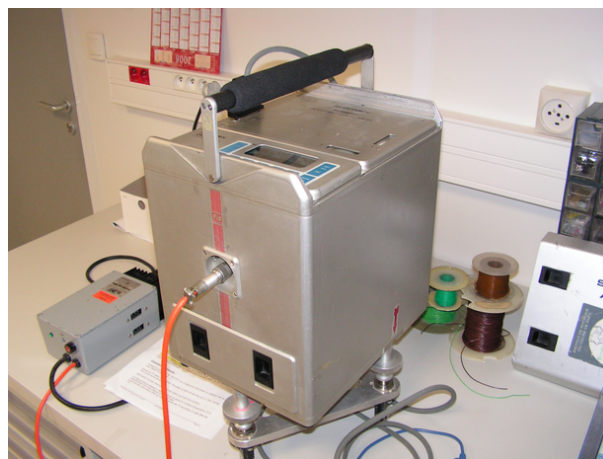
FIGURE 4.10: Gravimètre Scintrex CG3 utilisé dans le cadre des mesures à Palaiseau en 2009 et 2010.
