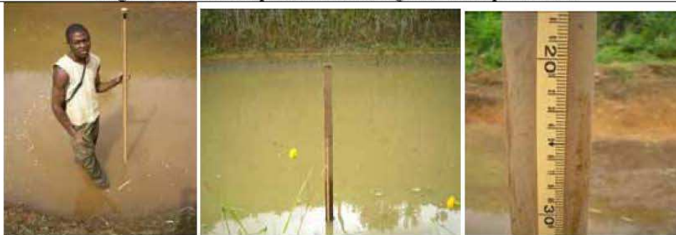
Figure 12: Comment mesurer les variations du niveau d'eau dans l'étang
