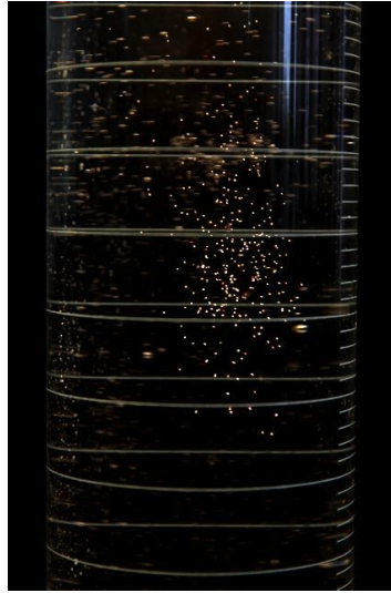
FIGURE 12.3 – Mesure de vitesse de sédimentation des grains dans une éprouvette graduée. On voit la ségrégation, les grains plus gros tombent plus vite que les grains plus fins.
