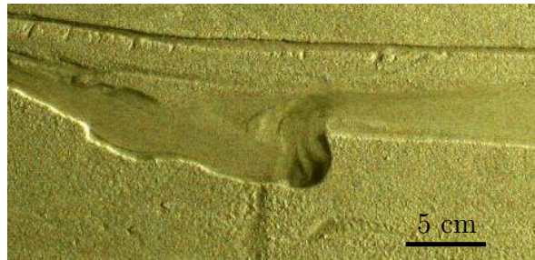
FIGURE 10.6 – Apparition d'une piscine, on voit le lit de la rivière suivre un cours rectiligne à gauche et à droite de l'instabilité.
