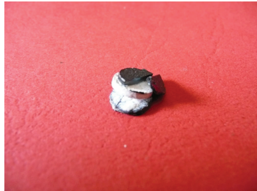
FIGURE 4.3.2: Schéma de la structure cofrittée et photographies d'un cofrittage ferrite / SiO 2 par SPS à 800 °C pendant 5 min sous argon neutre et sous une pression uniaxiale de 50 MPa.
