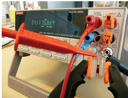
FIGURE 2.2.4: Photographie du banc de mesure de la résistivité électrique.
