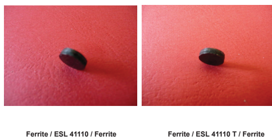
FIGURE 4.5.6: Photographies des pastilles Ferrite / ESL 41110 / Ferrite (à gauche) et Ferrite / ESL 41110 T / Ferrite (à droites) cofrittées par SPS à 800 °C pendant 5 min sous argon et sous une pression uni-axiale de 50 MPa.
