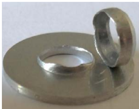
FIGURE 5.2 – Rupture du bord pour T_r = 0,25 (A1050-H14)
