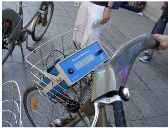
Figure VII.6 : Photo du capteur d'ozone placé dans le panier du vélo
