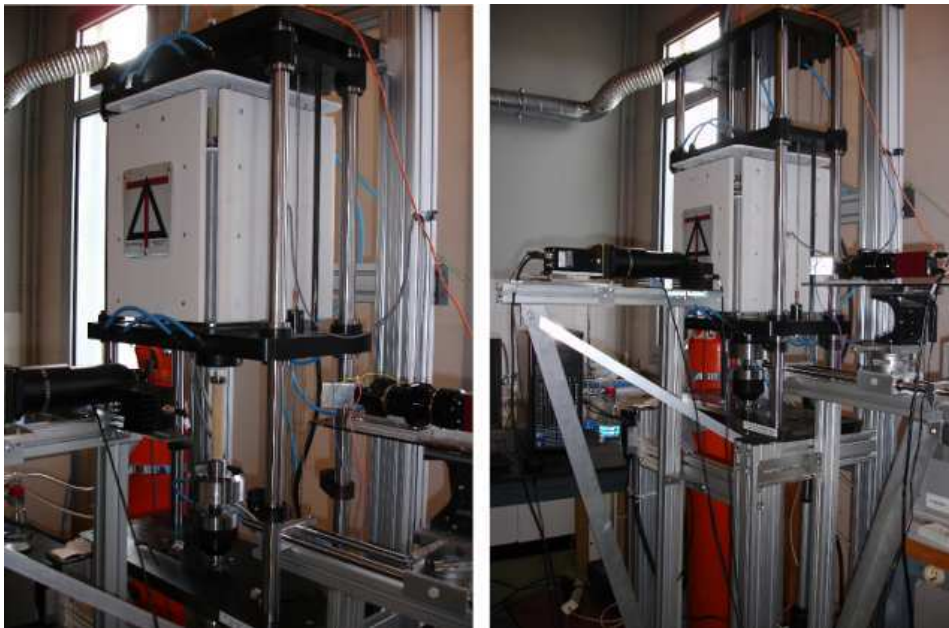
FIG. 2.14 – Presse utilisée pour les essais de compression uniaxiale, équipée de caméras optiques pour la Corrélation d’Images Numériques. A gauche, configuration pour les essais à température ambiante. A droite, configuration avec le four.
